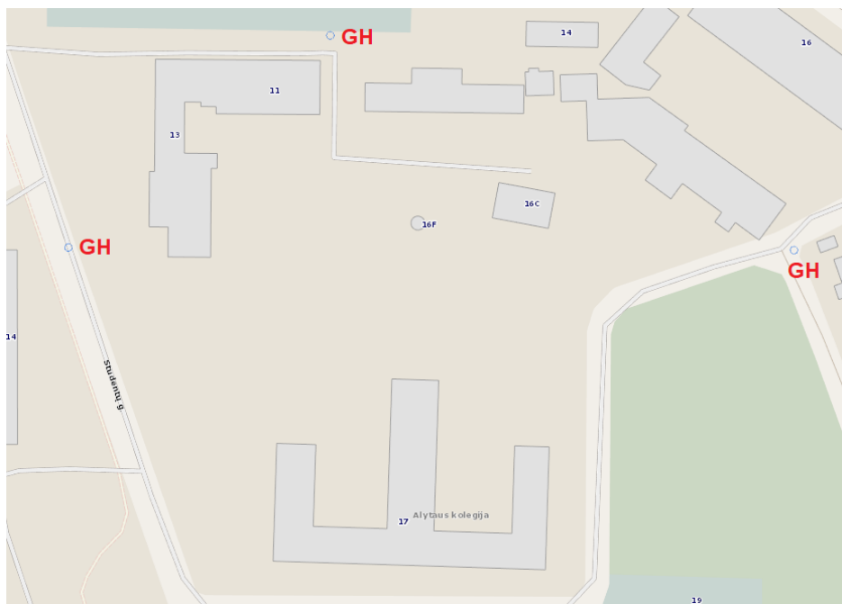
1 pav. Esami priešgaisriniai hidrantai (GH) ne toliau kaip 200 m nuo pastato
